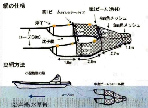
図1 小型ビームトロール網の仕様と曳網方法。
