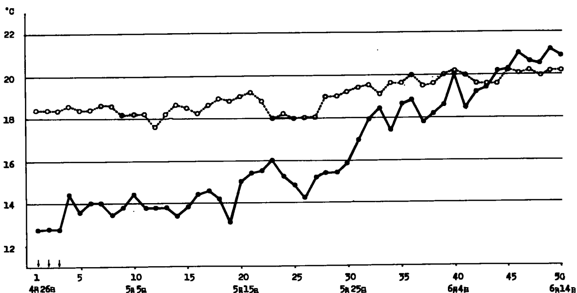
図 41. 実験期間中のびわ湖水 (●—●) と地下水 (○……○) の水温
