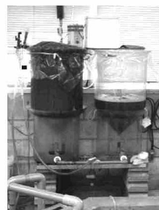
図 2-25 100L 槽連続培養装置
