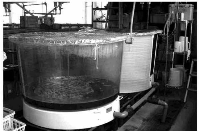
図 2-27 1000L 槽連続培養装置
