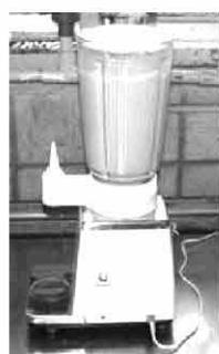
図 2-9 ミキサーによるイーストの溶解作業
