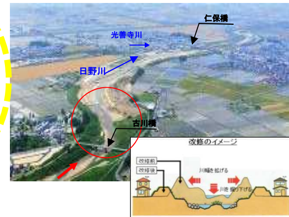
安曇川単独河川改良事業 (堤防強化:高水護岸・遮水シート工)
