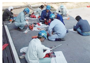
自分のチェーンソーを 分解して点検・整備 しました。
