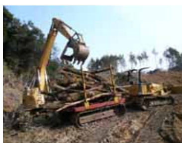
((株)北河技建工業(日野町地先) 改造搬出機による搬出作業
