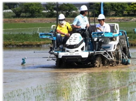
GPSによる直進機能付き田植機も登場しており強制落水の防止が期待できます(実演会 平成 29. 5. 23 開催)
