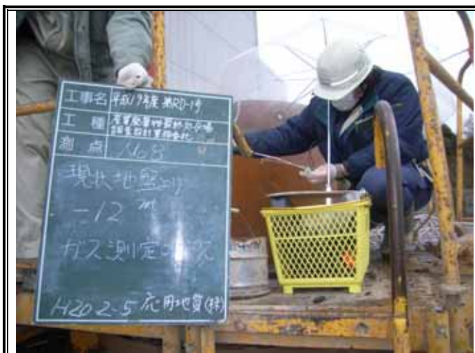
ガス測定状況(GL-12.00m)
