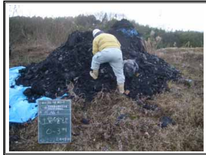
掘削廃棄物土(GL-3.00~-6.00m)
