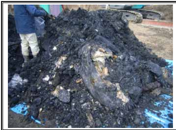
掘削廃棄物土(GL-3.00~-6.00m)
