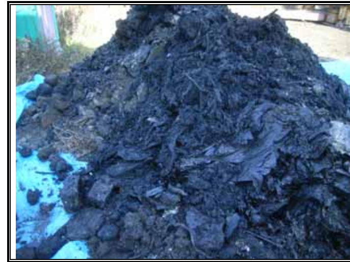
掘削廃棄物土(GL-3.00~-6.00m)
