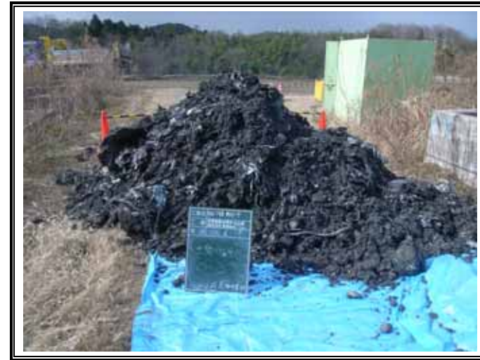
掘削廃棄物土(GL-3.00~-6.00m)
