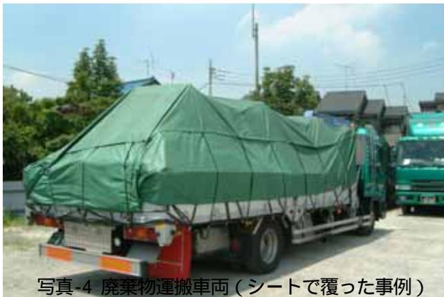
写真-4 廃棄物運搬車両(シートで覆った事例)
