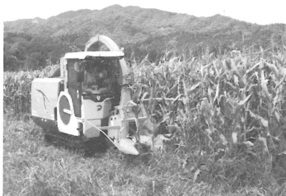
写真2 汎用機によるトウモロコシ収穫作業
