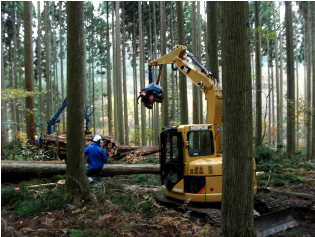
高性能林業機械（ハーベスタ・フォワーダ）による利用間伐（朽木）
