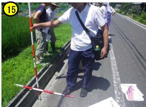
避難時の危険箇所 道路の沿い南側に水路の段差(約40cm)
