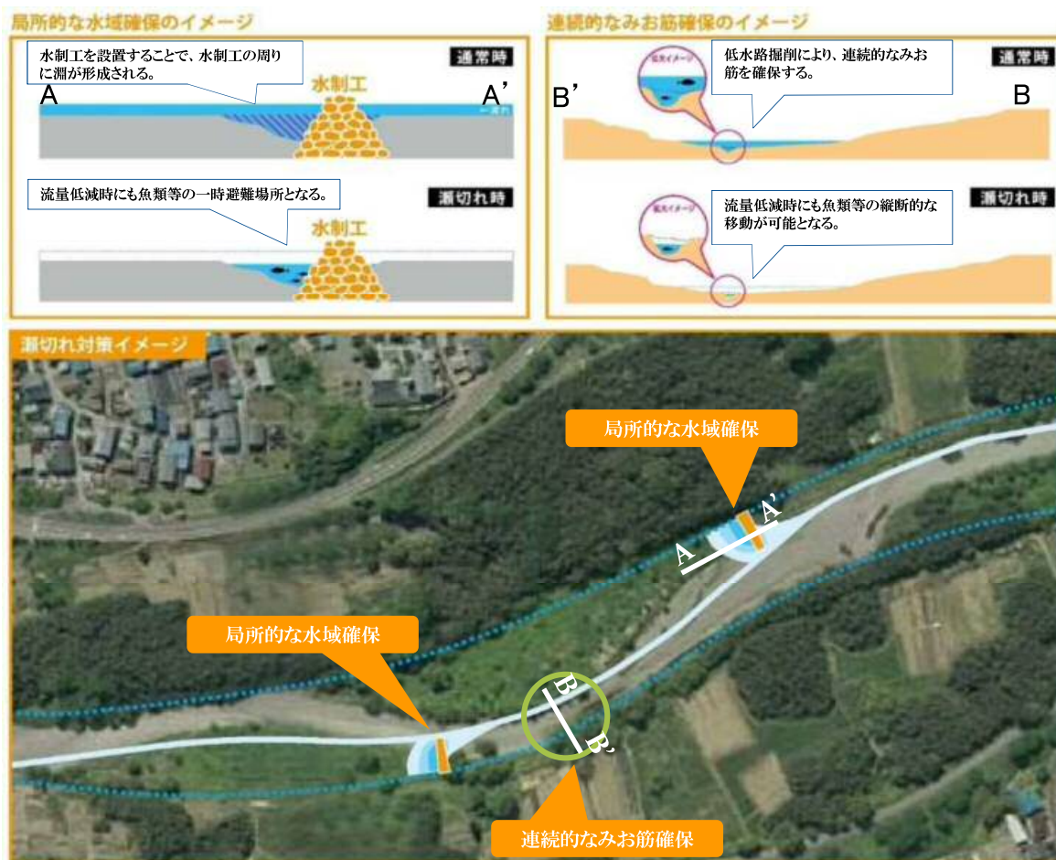
図 4.10 「局所的な水域確保」と「連続的なみお筋確保」の組み合わせイメージ
