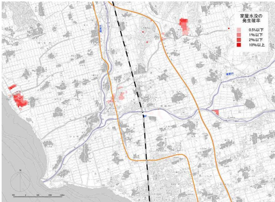
図 3.3.7 家屋の水没（浸水深 3.0m 以上）が生じる可能性（河道改修後）
