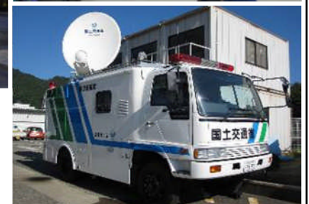
衛星通信車による回線の確保
