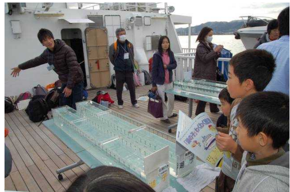
水槽の長さは1.5mですが、板を反転させ、奥の鏡に映るかを見ることで3mまで測れる
