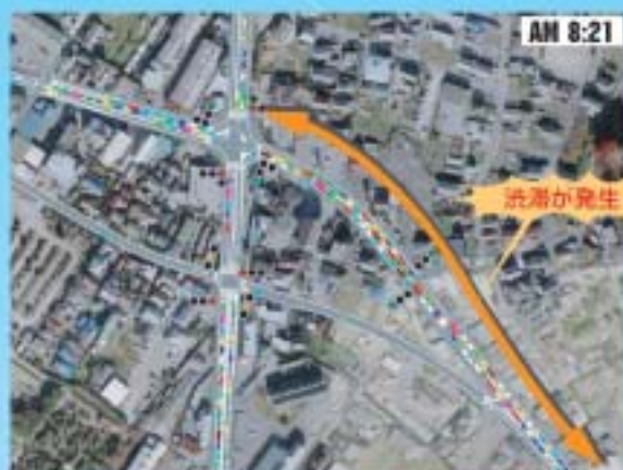
交通流シミュレーションによる現況再現結果（外町交差点周辺の状態）
