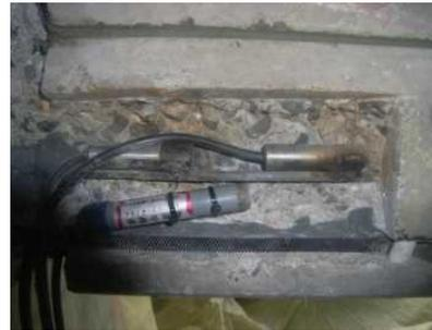
鉄筋に照合電極を設置
