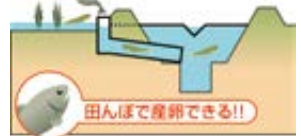
魚道設置による水田と排水路の落差解消
