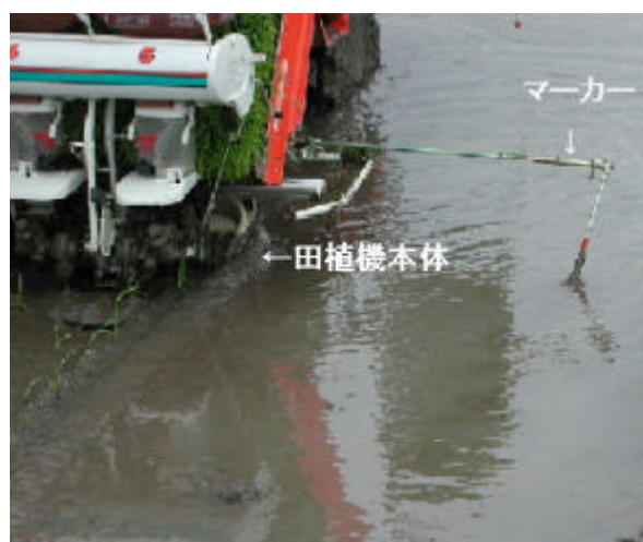
写真 - 12 従来型マーカーによる田植え作業 (田植え時に水があるとマーカーがつけたラインが見えない)
