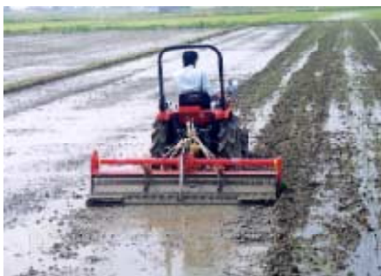
写真 - 9 水田ハローによる浅水代かき作業
