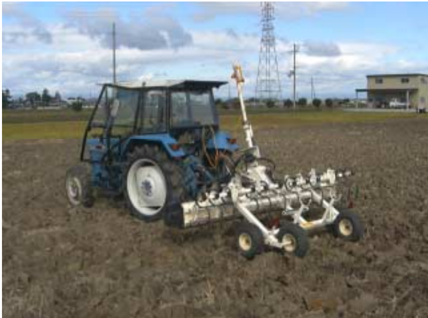
写真 - 1 レーザー均平機（作業前）
