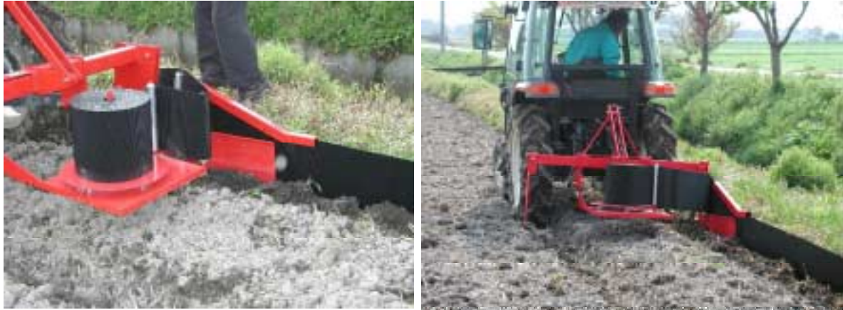
写真 - 3 畦シート埋設機による畦シート埋設作業
