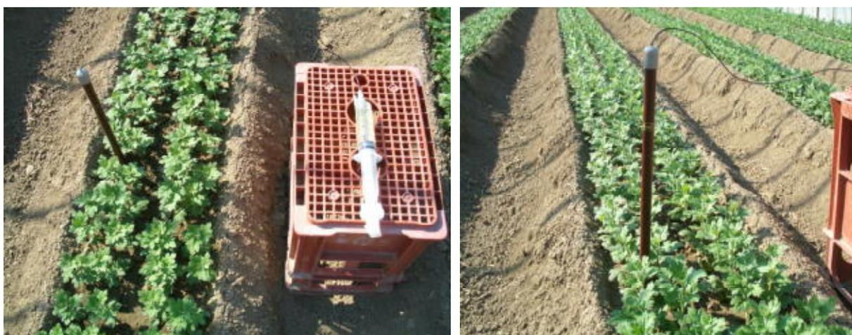
輪菊栽培（土耕栽培）での土壌溶液の採取風景：集液導管カップを地中に埋め込み注射器に土壌溶液を集める（約 12 時間で採取可能）。少量土壌培地耕でも同様に採取できる。商品名：ミズツール
