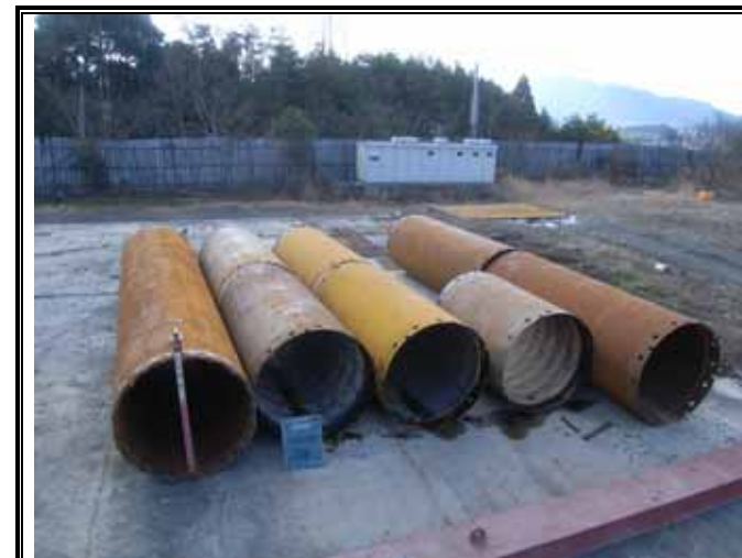
ケーシング \phi 1500 左から L=7m \times 1/3m \times 4/2m \times 1/4m \times 2
