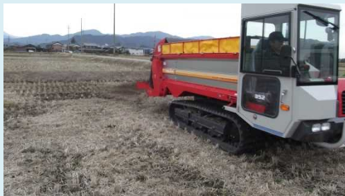
マニユアスプレッダーによる資材の散布
