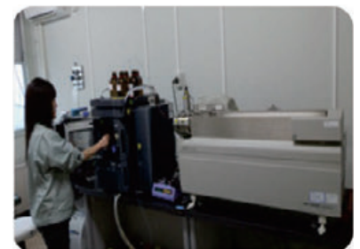
液体クロマトグラフ質量分析 (LC/MS/MS)による理化学検査 (県衛生科学センター)
