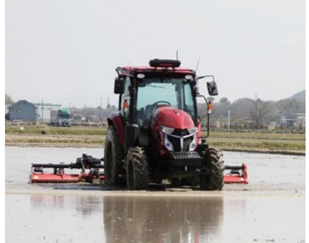
図1 ロボットトラクタでの代かき
