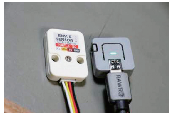
図3 安価な部品でハウス内の気温などを計測
