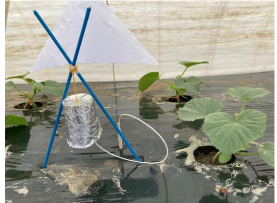
写真1 温度計の設置
