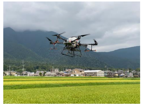
写真1 大型ドローンによる肥料散布
