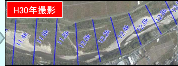
H30年には河道内に樹木が繁茂し、流路は左岸に固定。
