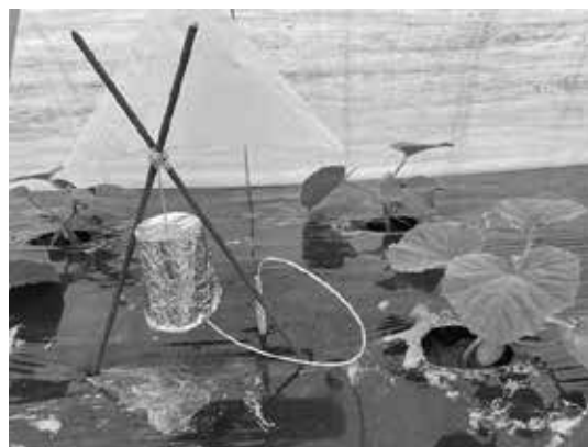
写真1 温度計の設置
