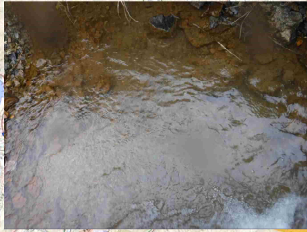
① スキー場ゲレンデ跡地付近 (目視：濁りなし 濁度計 3.17mg/l)
