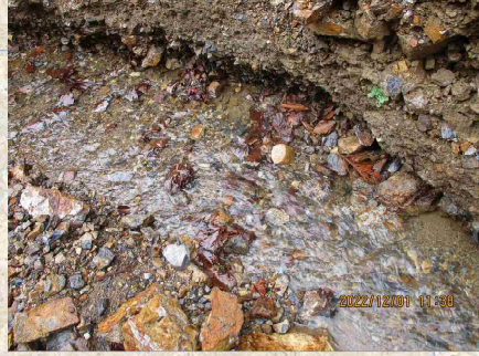
① スキー場ゲレンデ跡地 (目視：濁り無し 濁度計 1.53mg/l)
