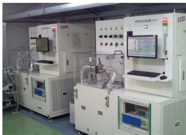
燃料電池 発電性能評価設備
