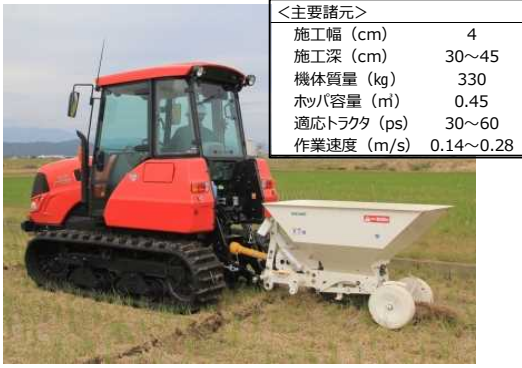
図 1. もみ殻補助暗渠施工機と主要諸元、施工断面模式図
