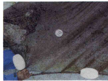
03年9月27日の模擬エリ網表層の汚損状況(左:新規防汚網・右:通常網)
