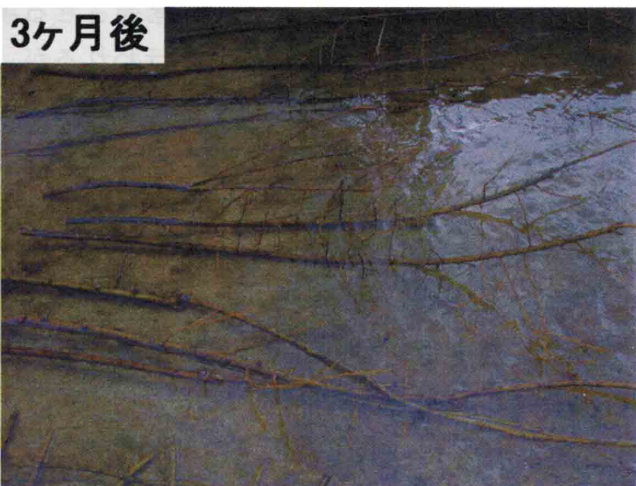
図3. 折れたアカメヤナギの枝を模した 供試苗木の3ヶ月後の変化. ※撮影は試験水面を清掃した後に行った.
