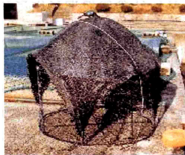
図2 調査で使用した遮光型カゴ網
