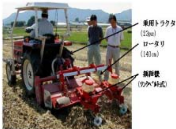
図1 作業機の概要
