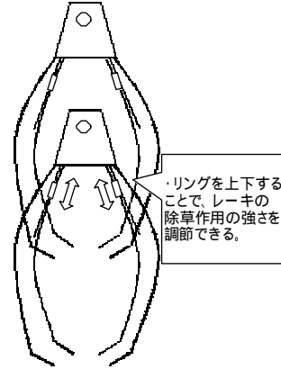
図1 供試した株間対応除草機の概略図
