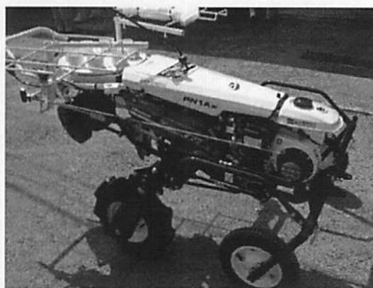
図 1 汎用野菜移植機(ヤンマー製 PN1A(W))
