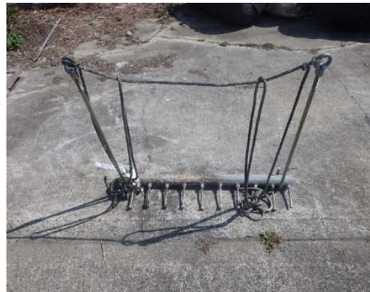
マンガン：一定規模以上の群落を移動させたり、分断する際に用いる。
