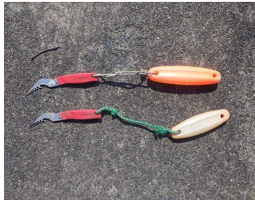
根掘り機：ランナー状に伸びた根等を掘り出す作業に用いる。
