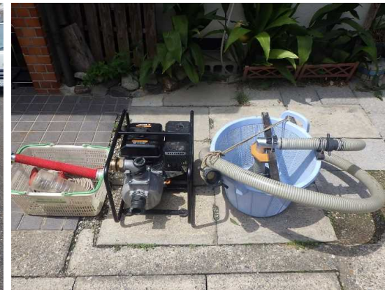
ジェットポンプ(ポンプ部)：高水圧で土壌を液状化させる。地中に深く張った根茎を掘り起こす際に用いる。
