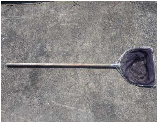
タモ網：水面に浮遊する植物体や、駆除中に拡散した植物断片を回収する作業に用いる。
