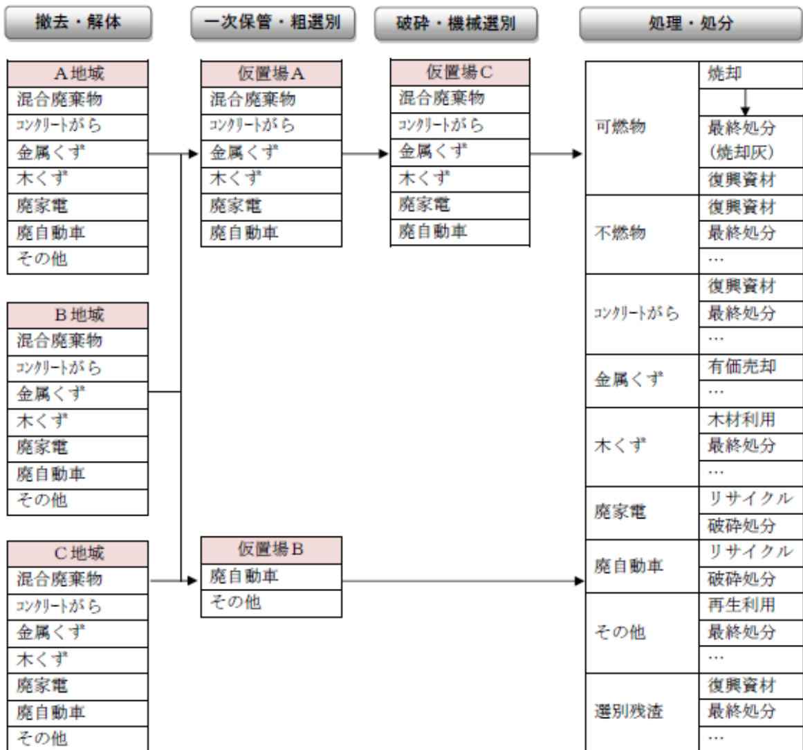
図表60 処理フロー（例） 【出典】災害廃棄物対策指針 技術資料1-11-3をもとに作成
