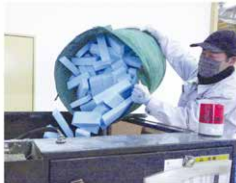
減容化設備への端材の投入
