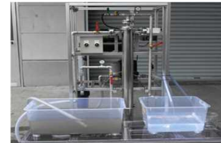
開発した小型浄水装置
