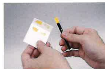
図付 4 変色試験紙の取り扱い
