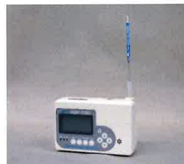
図 7 検知管とポンプ
