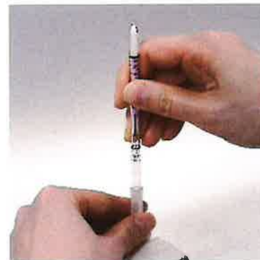
図付 1 検知管の取り扱い
