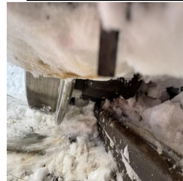
⑧脱線状況(進行方向左側車輪 後方から)
