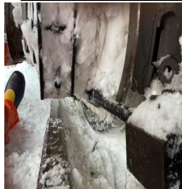
⑦脱線状況(進行方向右側車輪 前方から)
