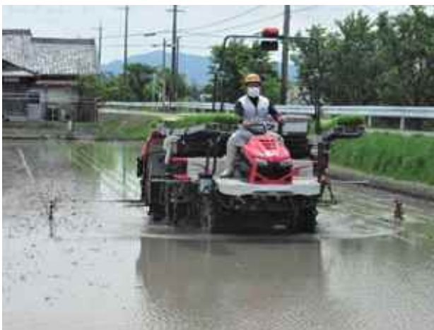
深い水深でも田から水を落とさずに田植えができる自動直進田植機*による田植えの実証
