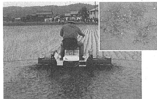
水田駆動除草機による除草作業（上） 機械除草後水面に浮いた雑草（右上） 駆動部分の拡大（下）
