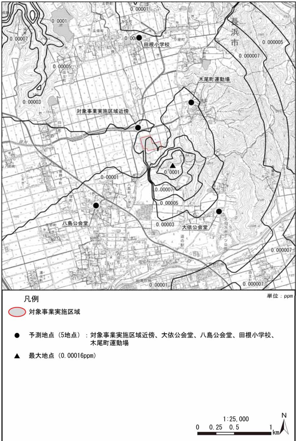
図 8.1-44 長期平均濃度予測結果[二酸化窒素 (年平均値)] (焼却施設) (寄与分: 補正あり)
