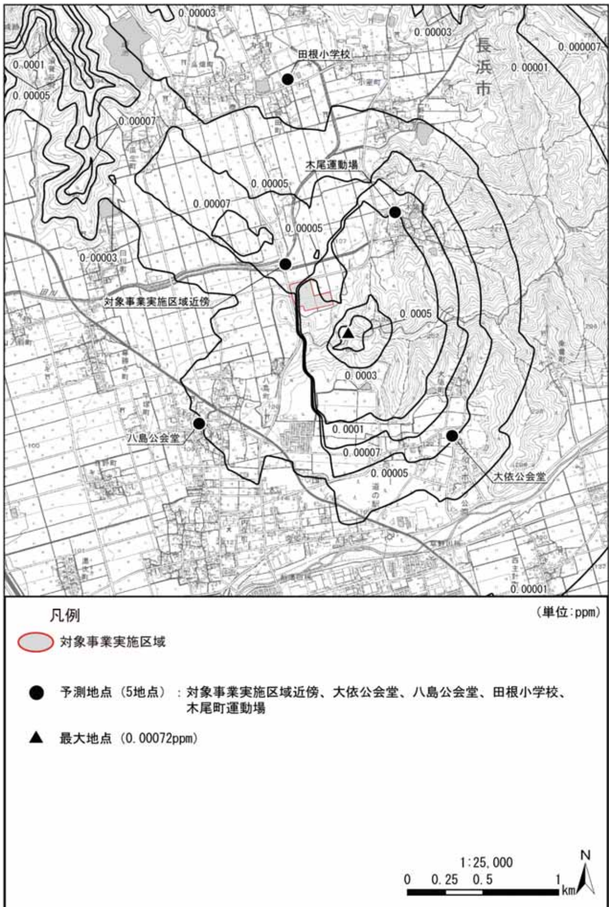
図 3.1-14(4) 長期平均濃度予測結果[塩化水素 (年平均値)] (焼却施設+バイオガス化施設+新斎場) (寄与分: 補正あり)
