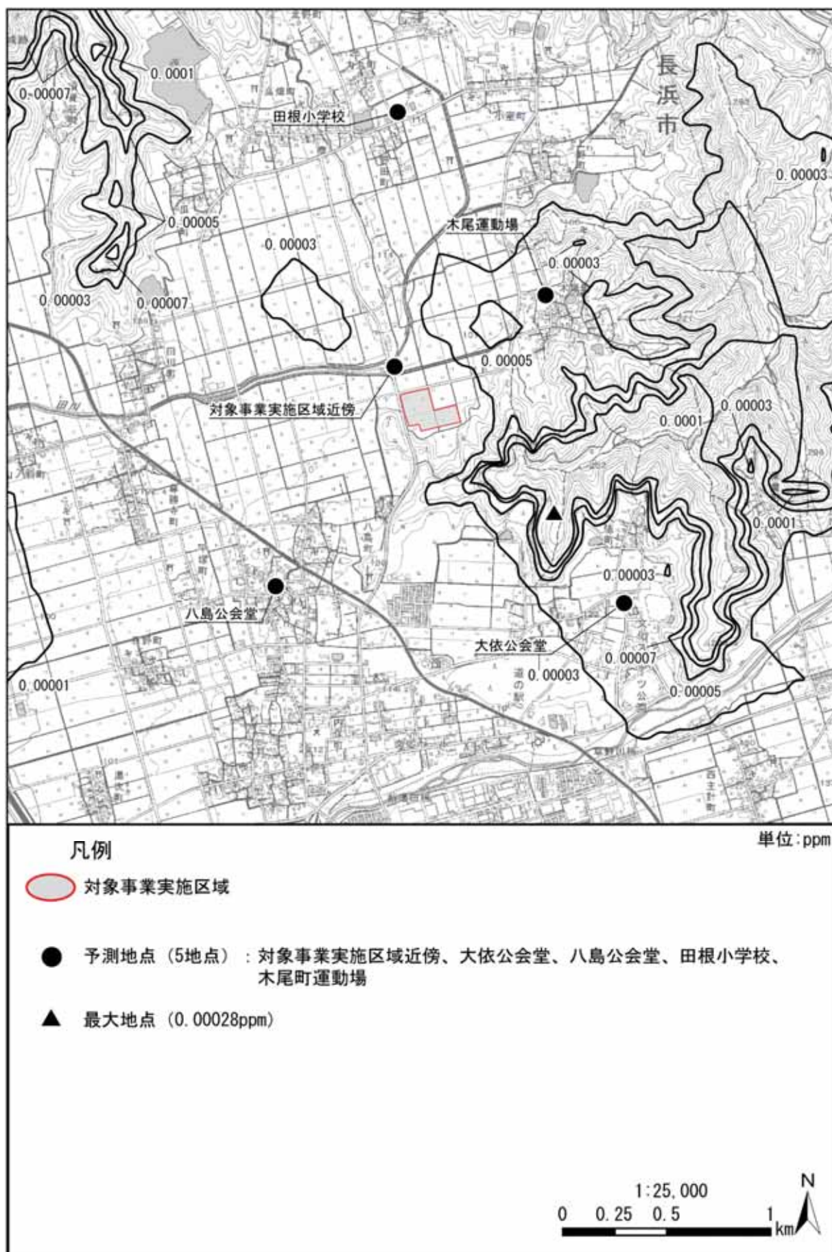
図 3.1-8(1) 長期平均濃度予測結果[二酸化硫黄 (年平均値)] (焼却施設) (寄与分: 補正なし)
