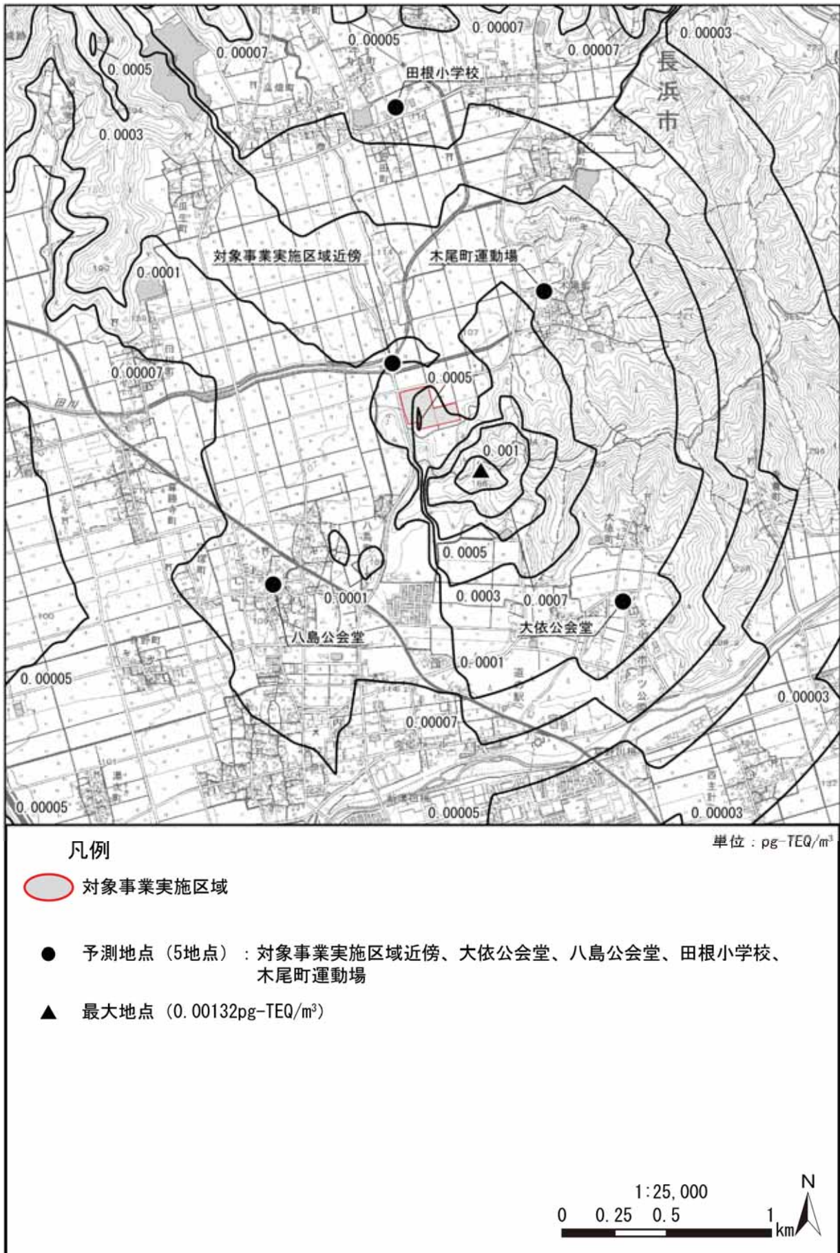
図 8.1-47 長期平均濃度予測結果[ダイオキシン類 (年平均値)] (焼却施設) (寄与分: 補正あり)
