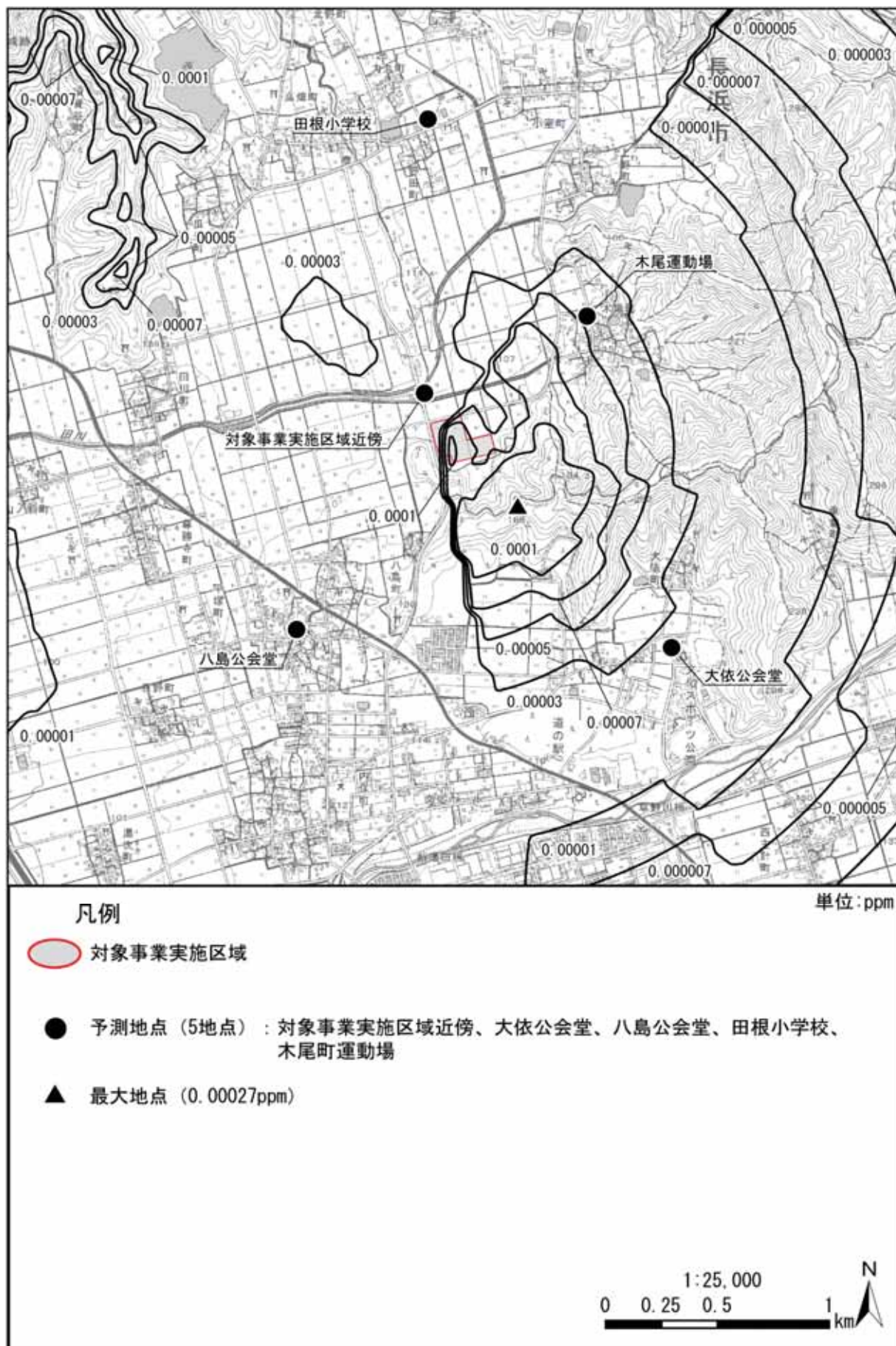
図 3.1-6(1) 長期平均濃度予測結果[二酸化硫黄 (年平均値)] (焼却施設) (寄与分: 補正なし)
