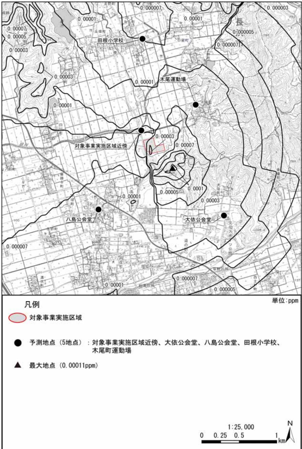
図 3.1-6(2) 長期平均濃度予測結果[二酸化窒素 (年平均値)] (焼却施設) (寄与分: 補正なし)
