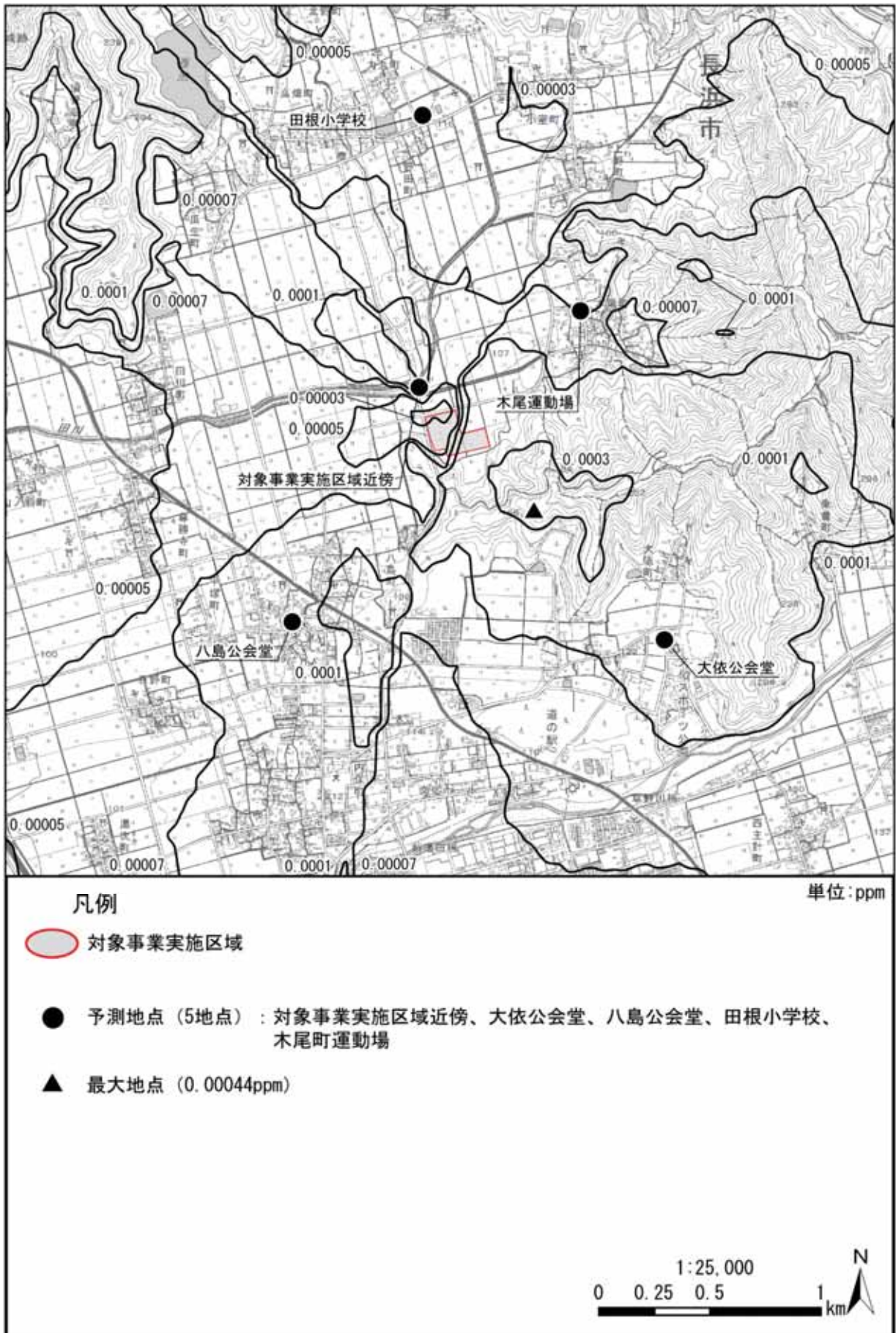
図 3.1-9(2) 長期平均濃度予測結果[二酸化窒素 (年平均値)] (焼却施設+バイオガス化施設) (寄与分: 補正なし)
