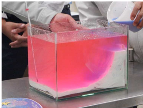
図表 3-6-1 琵琶湖の全層循環の模擬実験の様子
